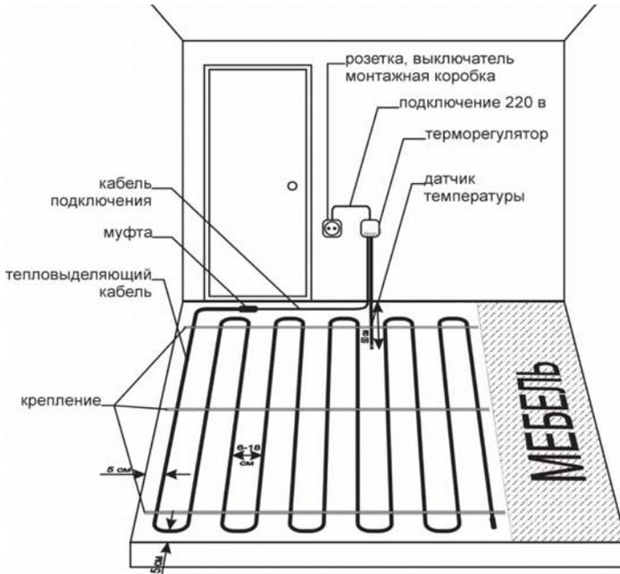
гофротрубки должен быть не менее 50 мм. Датчик температуры располагается на расстоянии 50–100 см от стены чуть ниже уровня пола. При правильной установке датчик температуры должен легко выниматься из защитной гофротрубки.
